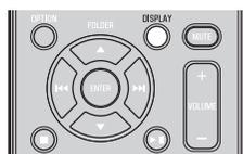
Il numero della cartella/del file viene visualizzato per diversi secondi quando inizia la riproduzione o si saltano le tracce. Premendo **DISPLAY** sul telecomando mentre un brano è in riproduzione o messo in pausa, le informazioni sul display del pannello anteriore cambieranno nel seguente ordine:
