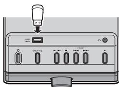
Verbinden Sie Ihr USB-Gerät mit dem USB-Anschluss auf der Oberseite. Einzelheiten zu abspielbaren Dateien finden Sie unter „HINWEISE ZU DISCS UND USB-GERÄTEN“ (S. 21).
