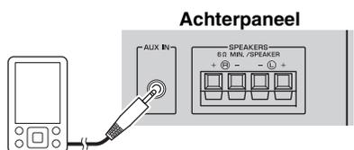
Sluit met een commercieel verkrijgbare stereo mini-plugkabel van 3,5 mm uw externe apparaat aan op de AUX-bus op het achterpaneel van deze eenheid.
