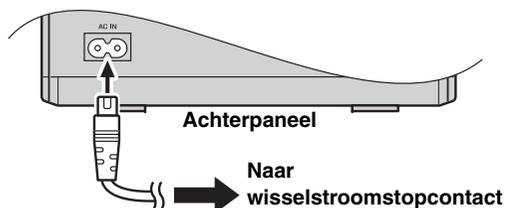
Als u alle verbindingen hebt aangesloten, steekt u het meegeleverde netsnoer in de AC IN- aansluiting en de stekker van het snoer in een wisselstroomstopcontact.
