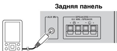
С помощью имеющегося в продаже стереокабеля с мини-штекером 3,5 мм подключите внешнее устройство к гнезду AUX на задней панели данного устройства.
