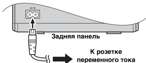
Когда все подключения выполнены, подключите прилагаемый шнур питания к разъему AC IN, а затем подключите штекер кабеля к розетке переменного тока.
