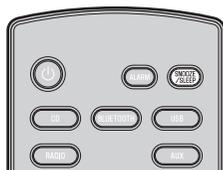
Appuyez plusieurs fois de suite sur **SNOOZE/SLEEP** pour régler le délai avant la mise hors tension de l'appareil.
