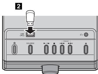
**1** Нажмите кнопку источника **USB**, чтобы выбрать USB-устройство в качестве аудиисточника. Если USB-устройство уже подключено, начнется воспроизведение.
