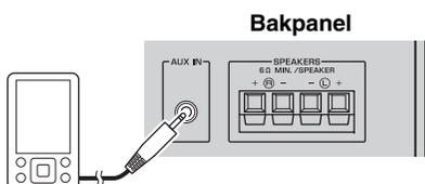
Anslut din externa enhet med en kommersiellt tillgänglig kabel med 3,5 mm stereo-minikontakt till AUX-uttaget på denna enhets bakpanel.
