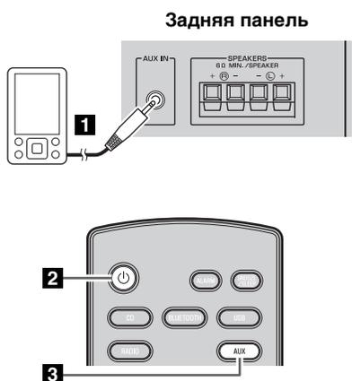
**1** С помощью имеющегося в продаже стереокабеля с мини-штекером 3,5 мм подключите внешнее устройство к гнезду AUX на задней панели данного устройства.
