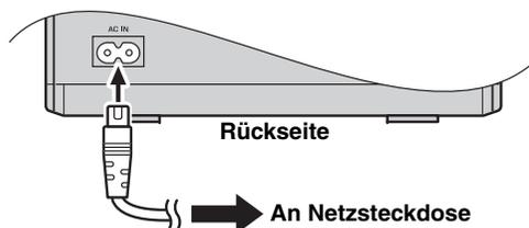
Wenn Sie alle anderen Anschlüsse vorgenommen haben, schließen Sie das mitgelieferte Netzkabel an AC IN und dann den Stecker des Netzkabels an eine Netzsteckdose an.
