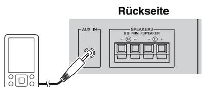
Schließen Sie ein externes Gerät mithilfe eines im Handel erhältlichen 3,5-mm-Stereominsteckerkabels an der AUX-Buchse auf der Rückseite dieses Geräts an.
