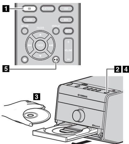
**1** Нажмите кнопку источника **CD**, чтобы выбрать CD-диск в качестве аудиосистемы. Если CD-диск уже установлен, начнется воспроизведение.
