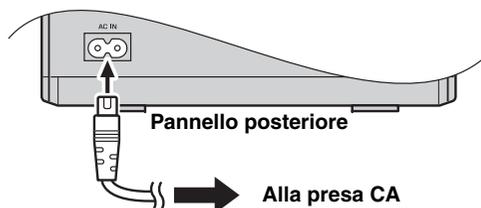
Una volta effettuate tutte le connessioni, collegare il cavo di alimentazione in dotazione alla presa AC IN, quindi collegare la spina del cavo a una presa CA.
