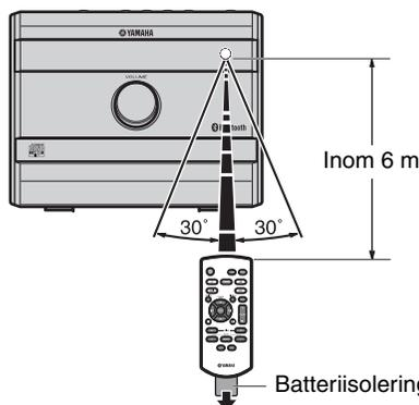
Batteriisoleringsark: Ta bort innan användning.
