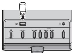
Подключите USB-устройство к USB-порту на верхней панели. Для получения подробной информации о воспроизводимых файлах см. раздел “ПРИМЕЧАНИЯ О ДИСКАХ И УСТРОЙСТВАХ USB” (стр. 21).
