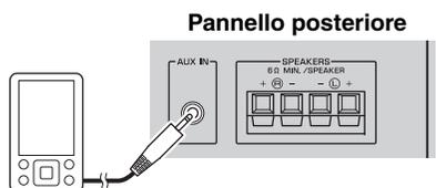
Collegare il dispositivo esterno alla presa AUX sul pannello posteriore dell'unità utilizzando uno spinotto da 3,5 mm stereo reperibile in commercio.
