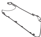
Кожух для укладки кабелей
