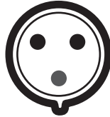
2P/3W 30 A 250 V Положение на 6 часов
